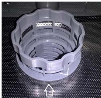
špatně zajištěný filtr
