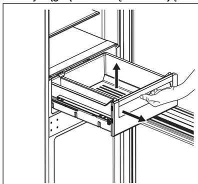
2. Wsunąć prowadnice do środka, aby zapobiec uszkodzeniu urządzenia przy zamykaniu drzwi.
